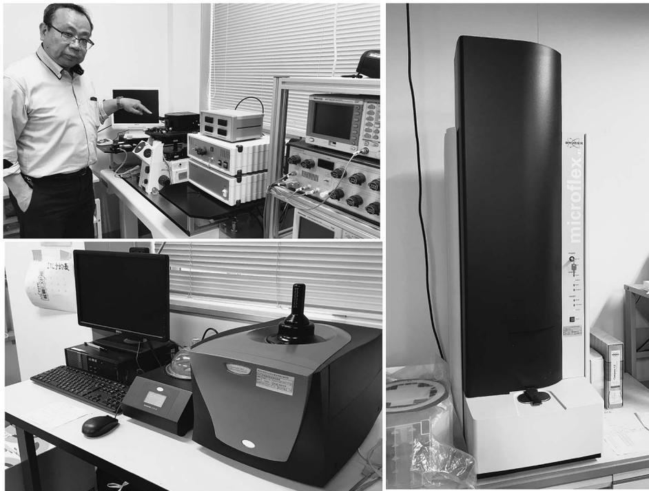
写真2 左上：高速 AFM と竹中先生，左下：ITC，右：MALDI-TOF MS
